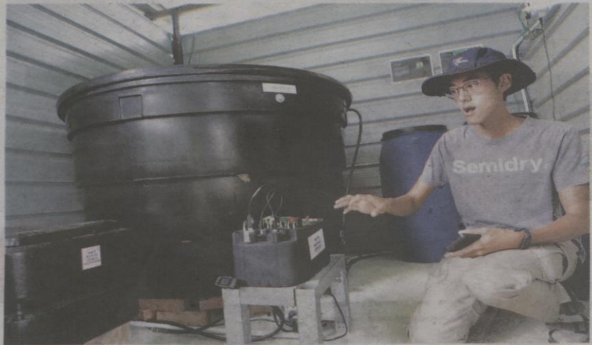
SISTEM NIDO berfungsi seperti otak yang mampu mengawal pelbagai parameter dalam pertanian dan menghubungkan pelbagai komponen untuk dioperasikan dari telefon pintar.
